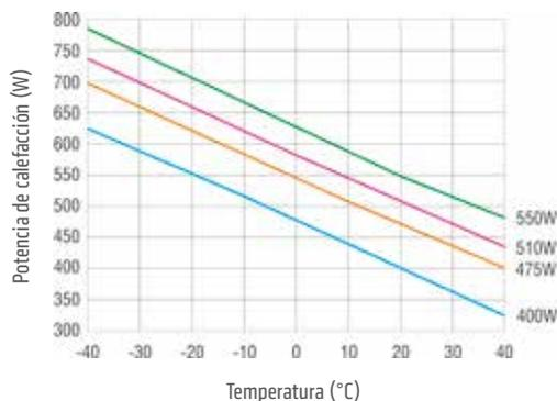
Potencia de calefacción / Diagrama de temperatura ambiente
