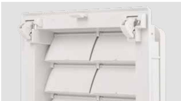
La nueva tecnología de salida "air-flap" elimina la necesidad de manta filtrante, mejorando a su vez el flujo de aire de salida. Además, utilizando la misma medida de recorte, aumenta la potencia y la eficiencia de circulación del aire. Otra ventaja, los flaps se cierran cuando el ventilador no está en funcionamiento, evitando que la suciedad penetre en el interior.
