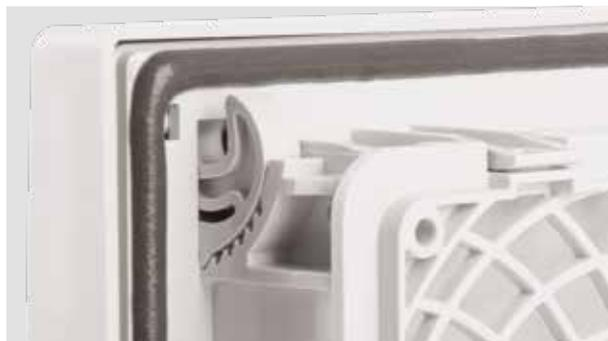
El Ventilador con Filtro Plus se monta desde el exterior y sin necesidad de herramientas, presionando los soportes incorporados con sistema tipo cremallera, garantiza una sujeción segura y estable en la envolvente. El instalador percibirá un feedback audible de que está correctamente instalado. El sistema es adecuado para diferentes grosores de pared (de 1 a 4 mm).
