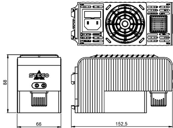
Resistencia Calefactora con termostato CSF 032
